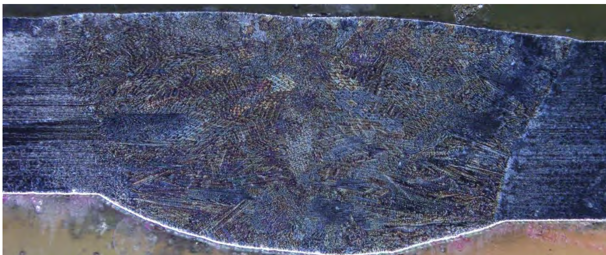
1. ábra: Makrofelvétel egy heterogén TIG kötés keresztmetszetéről, bal oldal 1.4376 acél, jobb oldal 1.4318 acél, (lemezvastagság 2 mm).
