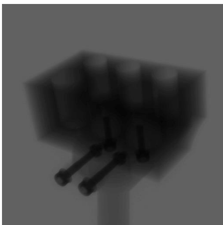
1. ábra: Egy adott pozícióban történt felvétel GE phoenix v|tome|x m ipari CT berendezésen.
