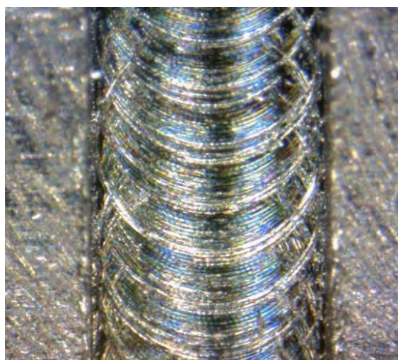
1. ábra: Mikromart horony erőteljes sorjaképződéssel és rezgésre utaló nyomokkal (C45, v_c = 60 \text{ m/min} , f_z = 4 \mu\text{m} , a_p = 0,05 \text{ mm} ).
